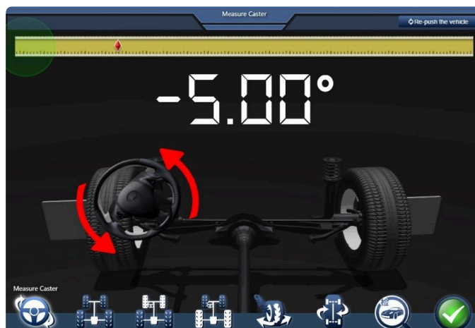
Figura 4.2.3-3 Rodar o volante para a esquerda
