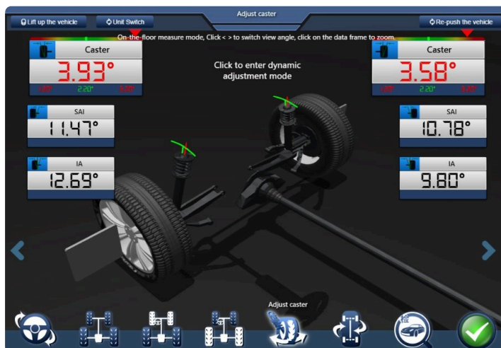
Figura 4.2.3-5 Resultados da medição do avanço (caster)
