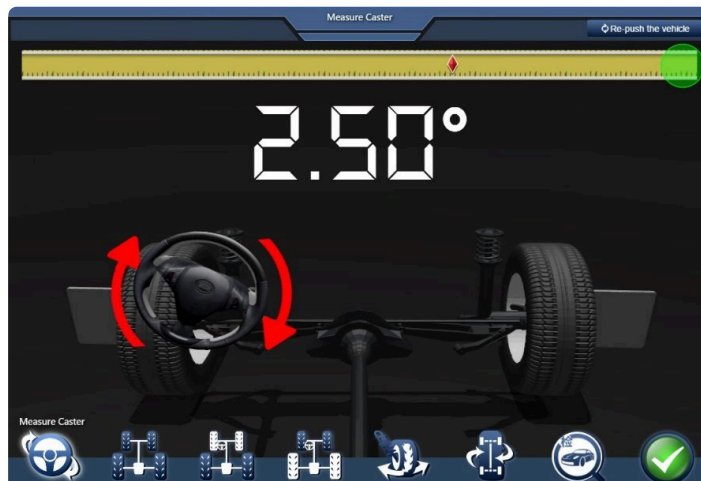
Figura 4.2.3-2 Rodar o volante para a direita
