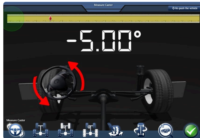
Afbeelding 4.2.3-3 Stuurwiel naar links draaien
