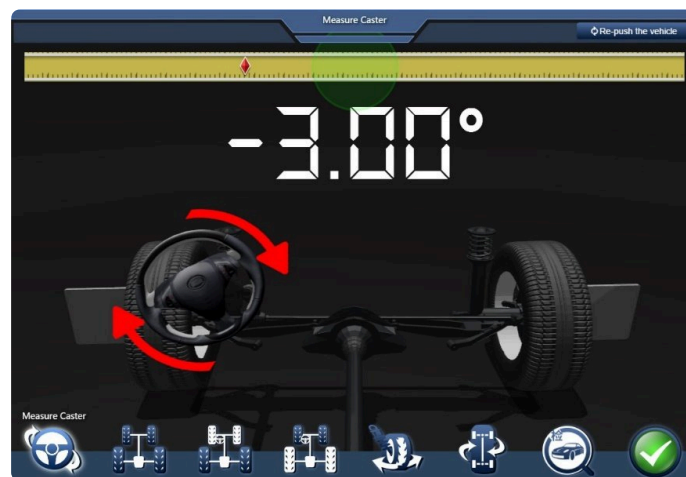
Afbeelding 4.2.3-4 Stuurwiel terug naar het midden
