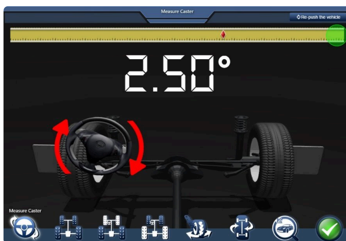
Afbeelding 4.2.3-2 Stuurwiel naar rechts draaien
