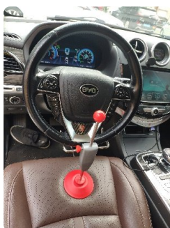
Figure 3.1-1 Mise en place du bloque-volant
